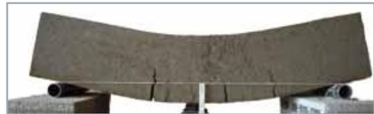
Mit Nanoalps® System SAFE wird bei Belastung eine bessere Verteilung erreicht, sodass ein Brechen des Materials minimiert wird.
